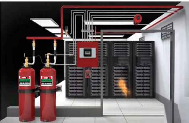
1. Hệ thống chữa cháy tự động FM200
